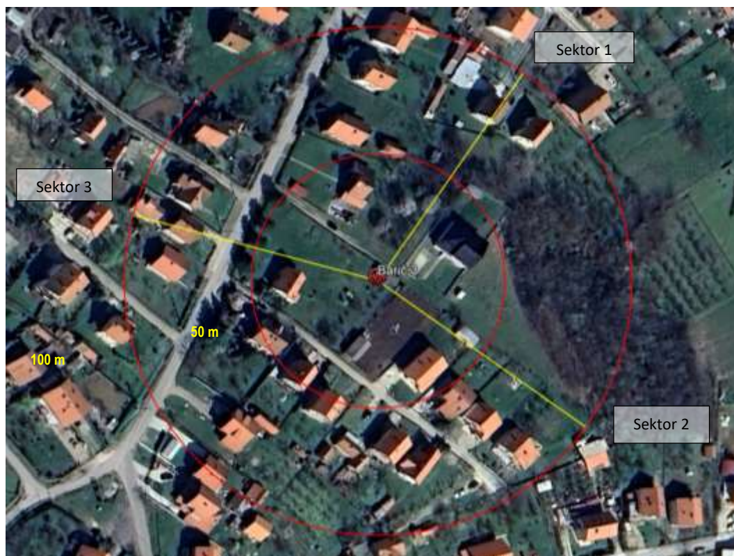
Slika 2.5 Pravci zračenja antenskih sistema BARIČ 3
