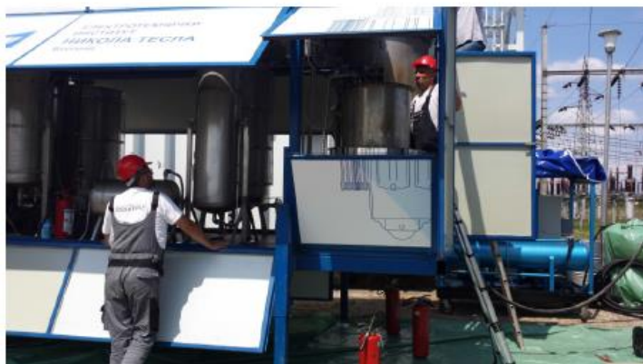
Слика 4.6. Мобилно постројење за деконтаминацију РСВ
