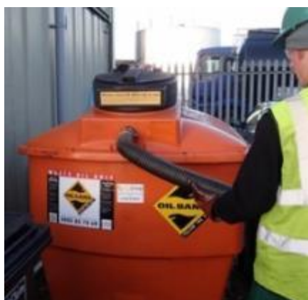
Слика 6.5. Изглед опреме за прихват коришћених уља
