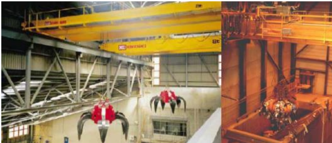
Слика 6.26. Изглед крана са грабилицом за отпад
